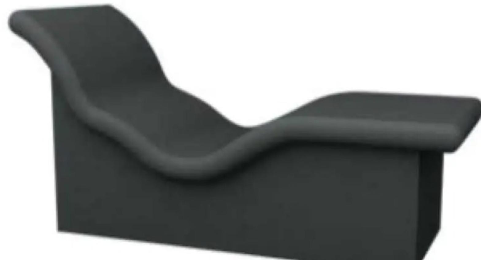
Ergonomik wellness yataklan ekstrüde polistren sert köpükten üretilmiş ve yüzeyleri cam elyaf ile güçlendirilmiştir. Mozaik veya benzeri malzeme ile kaplamaya hazır haldedir. 1855 x 700 x 888 mm ölçülendirir. Tercihe bağlı olarak yataklara termostatik kontrollü elektrikli ısıtma sistemi de monte edilebilir. Mozaik kaplama yüzeyi 8 m<sup>2</sup> dir.
