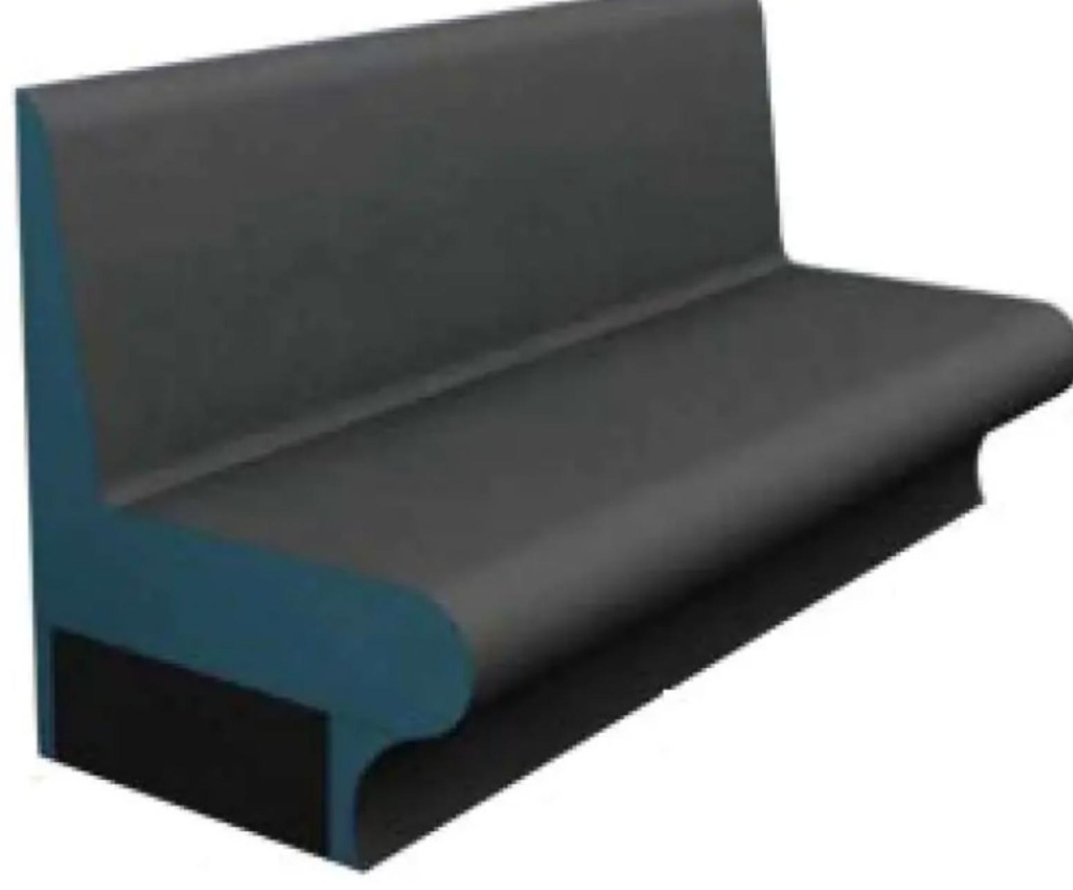
Ergonomik wellness oturma blokları ekstrüde polistren sert köpükten üretilmiş ve yüzeyleri cam elyaf ile güçlendirilmiştir. Plastik karışımı harç ile sıvanarak mozaik veya benzeri malzeme ile kaplamaya hazır haldedir. Oturma bloklarının boyutları 2,0 metredir.
